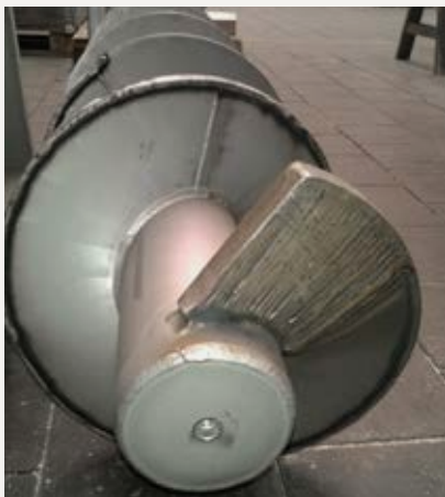
Neuzustand: Ansicht der Stirnfläche einer Waschpressschnecke mit aufgeschweißtem letzten Wendelviertel für den Verschleißschutz.
