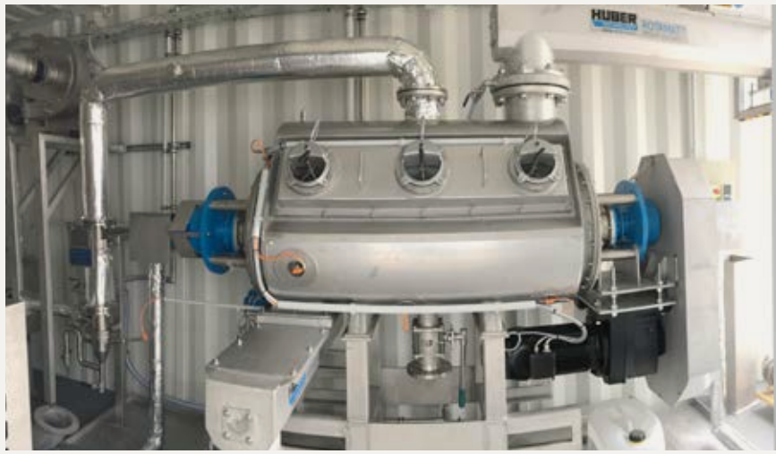
Versuchsscheibentrockner HUBER RotaDry® mit Zuführ- und Austragsschnecke.
