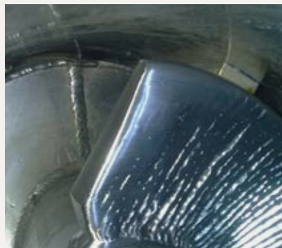
Der beginnende Verschleiß im Detail: an der äußeren Wendelspitze ist die Aufpanzerung abgetragen, die darunterliegende Grundwendel zeigt ebenfalls einen Materialabtrag. Ein solches Verschleißbild ist unkritisch, die Maschine kann bis zum nächsten Wartungsintervall betrieben werden.
