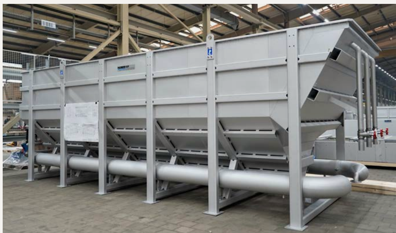
HUBER Druckentspannungsflotation HDF 30 im Werk (hier nur Behälterenteil).
