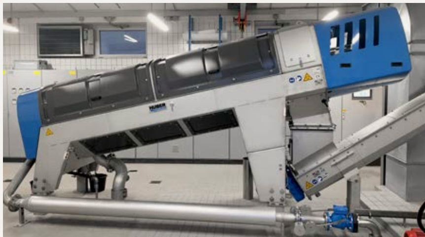
Digital vernetzt: Mithilfe der HUBER Cloud Solution HCS kann z.B. die Schlammwässerung der HUBER Schneckenpresse Q-PRESS® optimiert werden.
