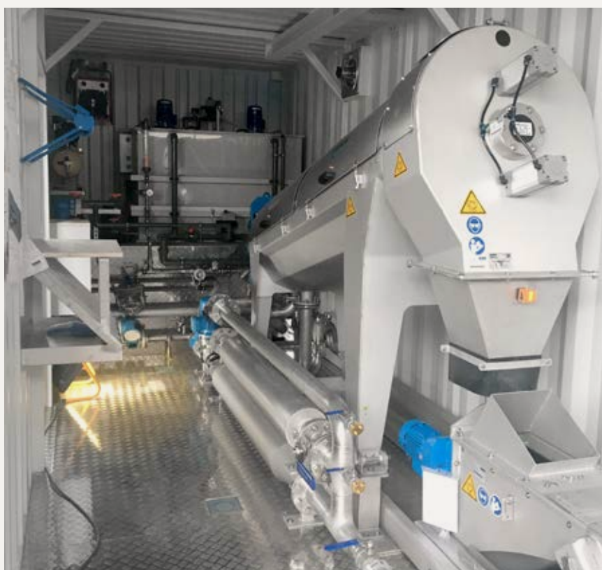
Innenansicht einer Vorführanlage der HUBER Schneckenpresse Q-PRESS®.
