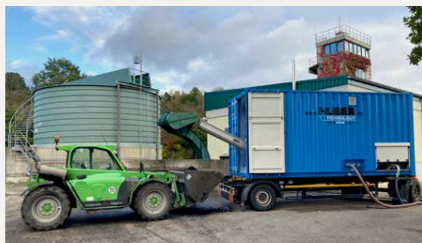
Typischer Aufbau: Eine Vorführanlage der HUBER Schneckenpresse Q-PRESS®.
