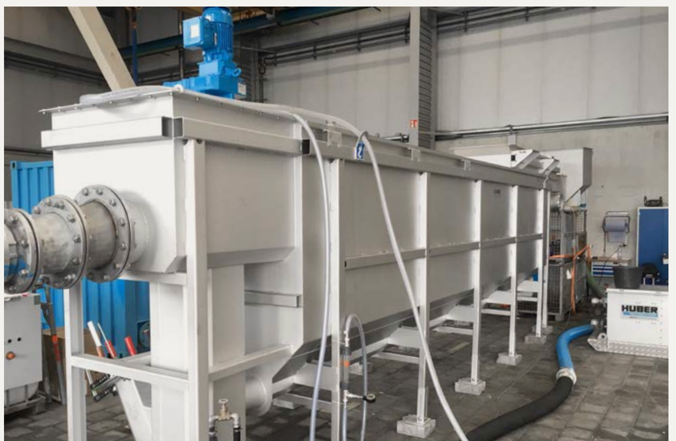
40 Liter pro Sekunde: Ein belüfteter HUBER Langsandfang ROTAMAT® Ro6 zur Prüfung.
