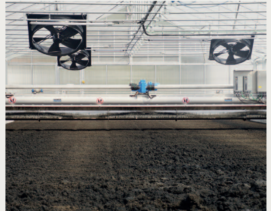
Mit dem HUBER Schlammwender SOLSTICE® ist die solare Trocknung ein Erfolg
