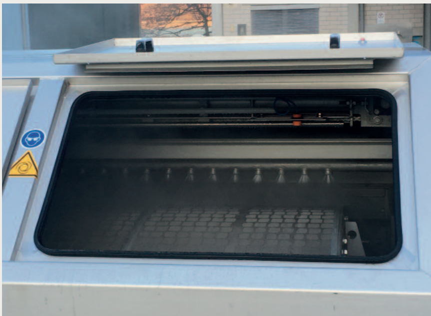
Keine Anpassung von Brauchwasserstationen notwendig durch die Nutzung von gesiebtem für die Reinigung mittels Spritzdüsenleiste mit innenliegender Rohr-/Düsenreinigungstechnologie
