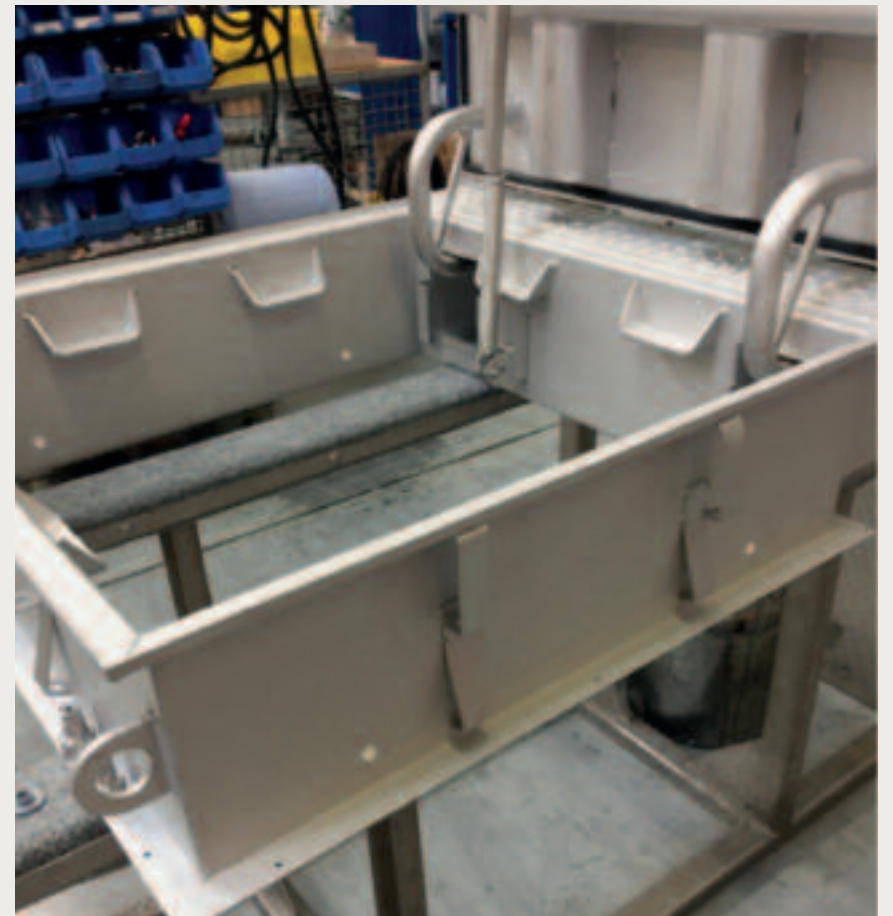
Die an die neue Norm angepasste Schachtabdeckung SD 7 mit neuem Rahmen
