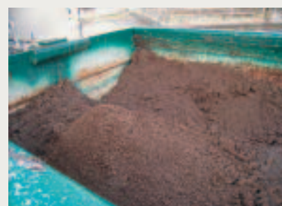
Entwässertes Klärschlamm mit einem Ausgangs-TS-Gehalt von 24 %
