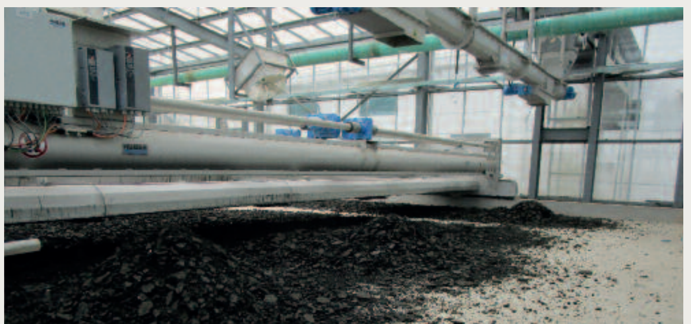
In Zhenjiang (China) wendet der neue SOLSTICE® 11 den Schlamm
