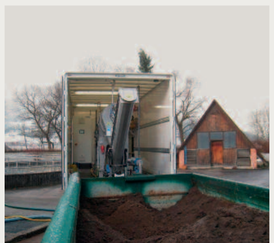
Die HUBER Schneckenpresse Q-PRESS® mit ausfahrbarer und hydraulisch hochschwenkbaren Austragschnecke.
