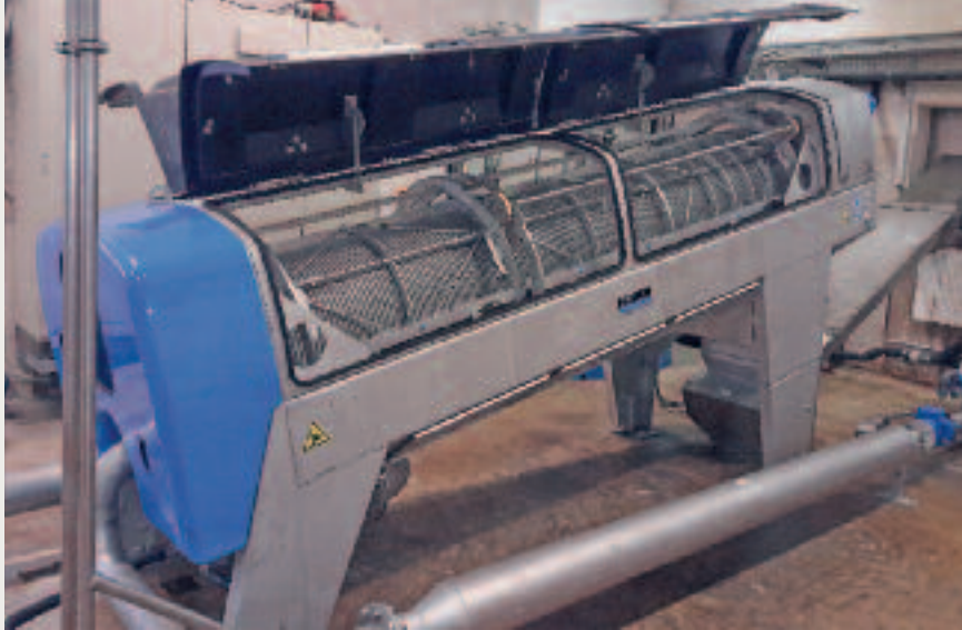
HUBER Schneckenpresse Q-PRESS® 620.2 mit geöffneter Abdeckung.
