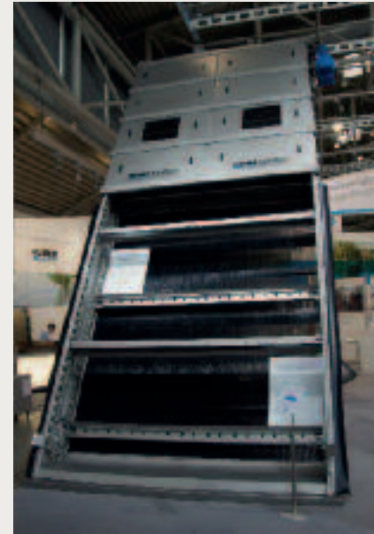
Einer der 3,2 m breiten HUBER Harken-Umlaufrechen RakeMax® Hybrid als Feinrechen mit Spaltweite 3 mm:
