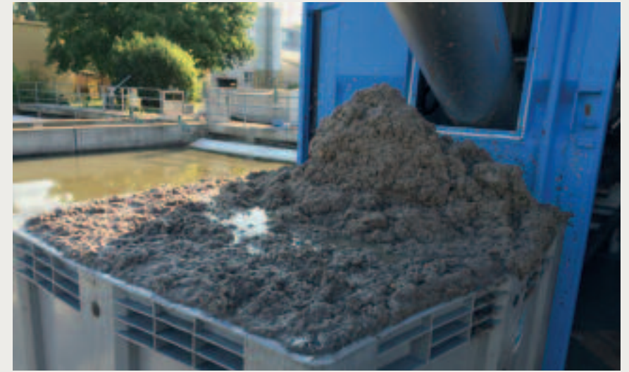
Abb.8: Vorentwässertes Feinstsiebgut zur Faulung durch HUBER Waschpresse WAP® liquid
