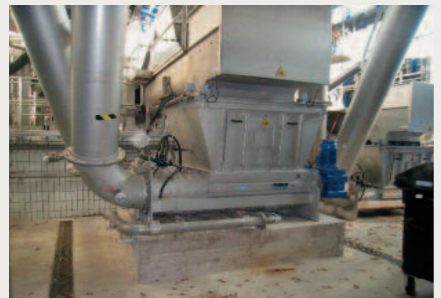
HUBER Waschpresse WAP 2x8 mit einer Durchsatzleistung von je 16m³/h
