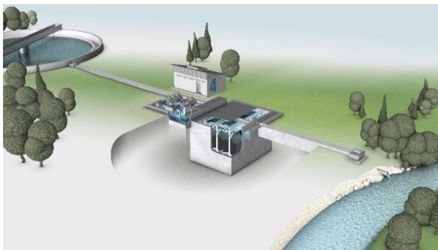
Abbildung 17: HUBER hat auch Lösungen entwickelt, um Wasser noch weiter als bisher üblich zu reinigen. Mit einer sogenannten 4. Reinigungsstufe werden Spurenstoffe wie z.B. Arzneimittel aus dem Abwasser entfernt, indem diese Substanzen an Aktivkohle adsorbiert werden.
